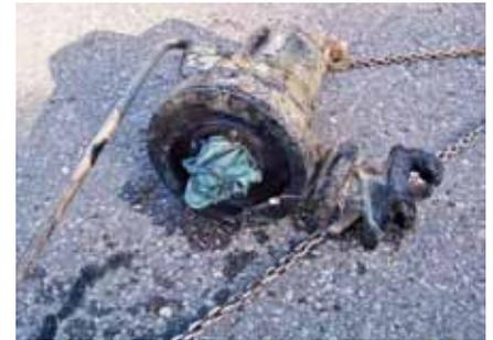
So ein Putzfetzen kann eine noch so starke Pumpe außer Betrieb setzen – passiert vor wenigen Wochen in Mauthbrücken – Kosten der Reparatur nahezu gleich hoch wie eine neue Pumpe!
